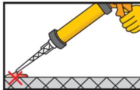
Bombee unas dos veces hasta que las dos partes salgan de forma uniforme. No usar este material. Libere la presión de la pistola y limpie la entrada del cartucho con un trapo.
