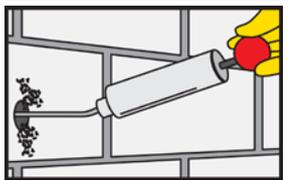
La perforación se tiene que limpiar con una bomba manual o con aire comprimido, empezando desde el fondo de la perforación. (al menos dos veces) Importante: utilice compresores sin aceites.
