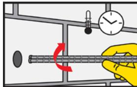
Inserte el anclaje con un movimiento giratorio en la perforación rellenada. Tiene que salir un poco de adhesivo del hoyo.
