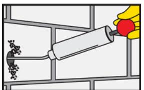
La perforación se tiene que limpiar con una bomba manual o con aire comprimido, empezando desde el fondo de la perforación. (al menos 2 veces) Importante: utilice compresores sin aceites.
