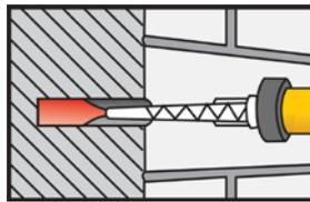
Inyecte el adhesivo en el hoyo empezando desde la parte inferior, mientras retira lentamente el mezclador estático. En cualquier caso, evite que el aire quede atrapado. Para hoyos profundos puede utilizar tubos de extensión.
